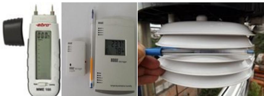
Nota: Izquierda: de lectura directa; centro: de tipo HOBO; derecha: abrigo meteorológico de una estación automática. Adentro están los sensores eléctricos de temperatura y humedad.
